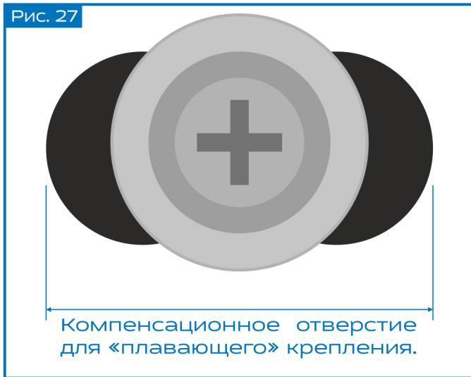
1. По типу «плавающего крепления», то есть в стеновом профиле нужно просверлить два примыкающих друг к другу отверстия, а финальное врезание самореза нужно производить в точке примыкания этих отверстий (Рисунок 27).
